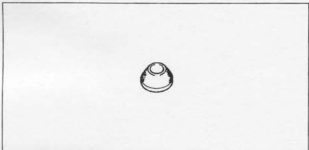
Adattatore estrattore rotore, Ø 9.5: 57001-1151
