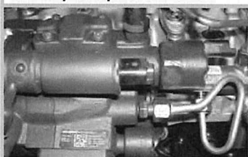
Pompa alta pressione Siemens
